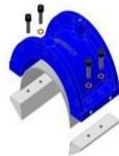
VP 136-140 MIS INJ Gehäusehalbschale mit XAR Schutzschale.
